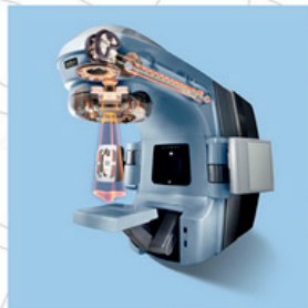
Gammastråler kan dannes i en lineær accelerator LINAC
